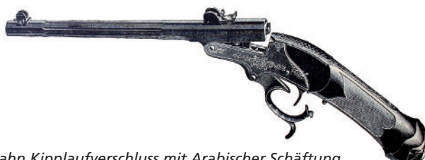
Langenhahn Kipplaufverschluss mit Arabischer Schäftung
